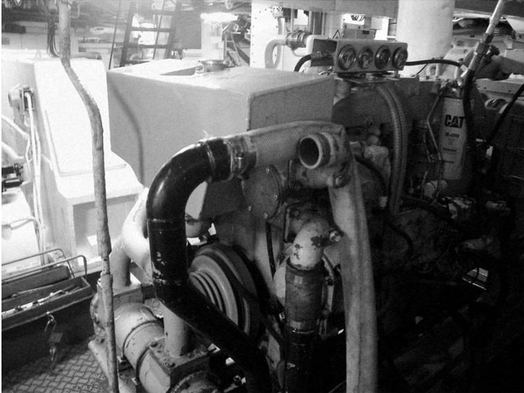
(Generador de puerto con corte en su línea de alimentación de enfriamiento, se aprecia reparación de fortuna con una manguera alimentado directamente desde el ramal de incendio, fotografía facilitada por Felipe Fernández, fotógrafo oficial del BMS Merino)
