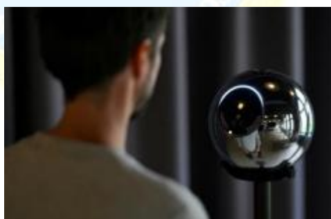
Imagen N° 3 Sistema que capta imagen de la retina y la digitaliza a cambio de moneda digital. Fuente: ( https://worldcoin.org/ , 2023).
